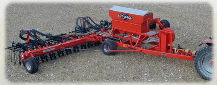
Une trémie de 3000L peut être adaptée sur les châssis en A, pour transformer votre herse de grande largeur en un semoir extrêmement rapide. Avec une régulation de haut niveau (Artémis), pour alimenter jusqu'à 14,4m de large, avec toujours 2 choix : semis en ligne (15cm) sur les 2 premiers rangs de dents, ou semis à la volée avec des éclateurs. Possibilité de doser l'engrais ou plusieurs graines différentes.
