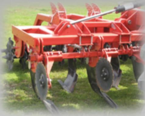
Sur les dents à double ailette, les coutres ne sont pas soumis à des poussées latérales importantes comme sur les lames dissymétriques, l'appareil a ainsi une meilleure stabilité. Les ailettes sont en matériau résistant à l'abrasion, de 20mm d'épaisseur avec un bord d'attaque en carbure de chrome. En option, les socs peuvent recevoir des plaquettes d'usure en carbure de tungstène pour les situations très abrasives.
