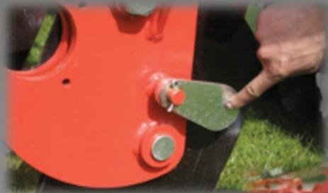
Axe de sécurité de gros diamètre à amorce de rupture.
