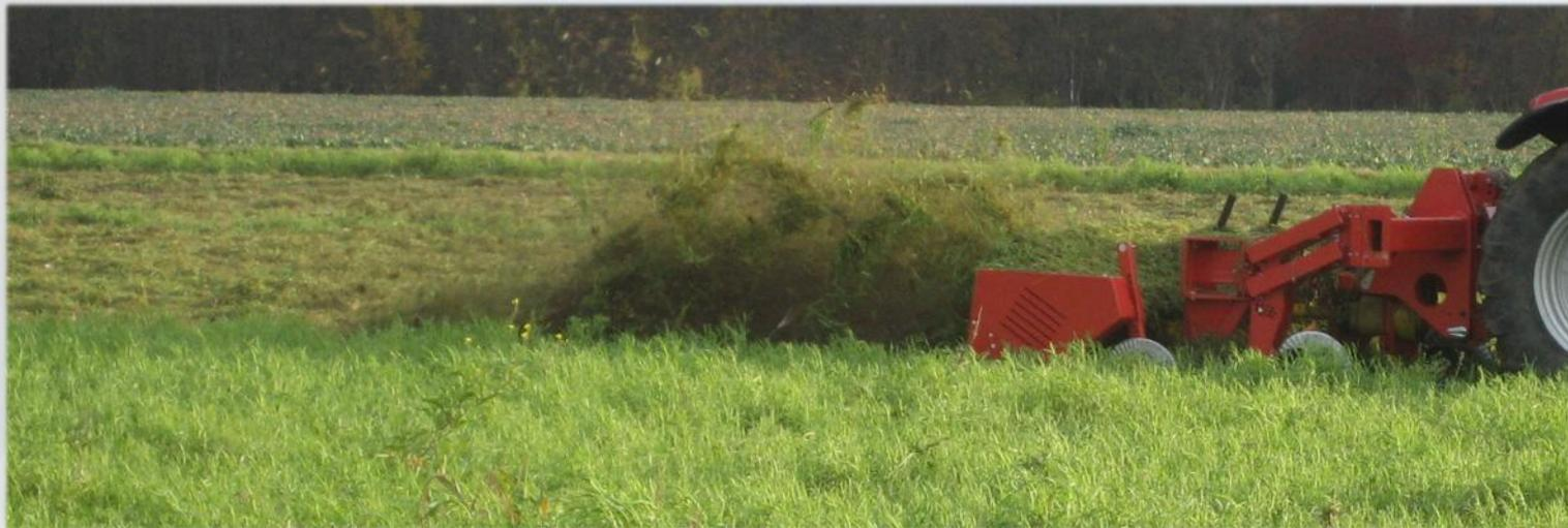
Le rotor est supporté par des bras à suspension hydropneumatique qui permet de le maintenir et de surfer pour projeter un minimum de terre et utiliser aussi peu d'énergie que possible tout en restant efficace sur les adventices. Le rotor travaille dans tous les cas au dessus des lames.
