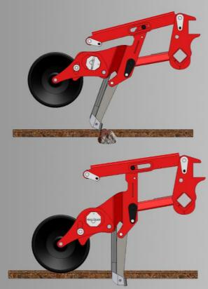
Son système breveté offre un suivi de terrain performant, avec un débattement pouvant atteindre 30cm. La pression d'appui est réglable avec les roues sur le châssis.
